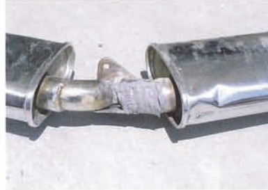
マフラー排気漏れ
