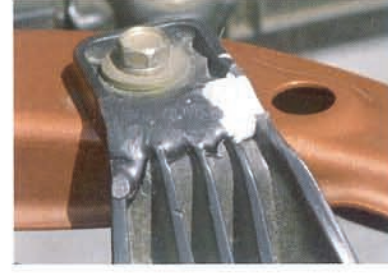
衝突時のライトステー折れ 針金と併用します。
